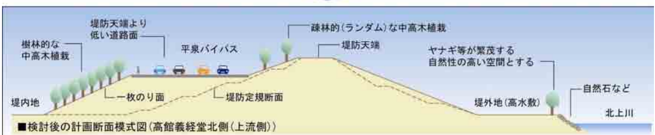
図-8 高館義経堂付近の堤防・バイパス断面模式図
