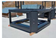
写真5 マルチ訓練ユニット 大きさ：幅2,400×奥行2,400×高さ1,100mm 重さ：約550kg
