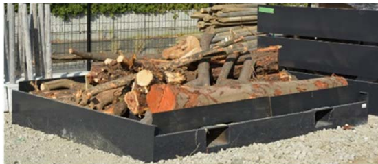
瓦礫が広がる被災地での状況を再現、この上を歩いて進入 木製瓦礫ハザードユニット(左)とRC製瓦礫ハザードユニット(右)
