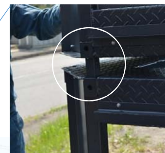
ずり落ち防止のダボによる安全確保
