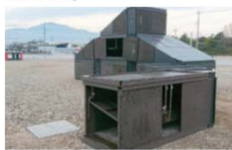
写真7 5種類のユニットを用い、倒壊家屋を再現
