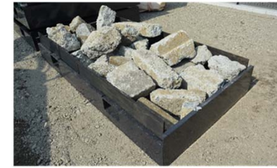
瓦礫が広がる被災地での状況を再現、この上を歩いて進入 木製瓦礫ハザードユニット(左)とRC製瓦礫ハザードユニット(右)
